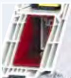
Großvolumige Verstärkungskammern werden zusätzlich mit 3,5 mm starken 4-Kant Stahlprofilen ausgesteift, die mit dem Grundkörper verschraubt werden. **Sicherheitsrelevante Bauteile werden zugfest im Stahl verschraubt.**
