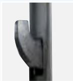
3-fach Sicherheitsverriegelung mit 2 massiven, durchsägegesicherten Schließhaken aus Stahl. **Die Schließhaken greifen von unten tief in die Stahlschließstücke und "hinterkrallen" diese. Das Auseinanderdrücken von Türblatt und Rahmen wird wesentlich erschwert.** Zusätzlich sind die Schließhaken in Verschlussstellung blockiert und können so nicht manuell zurückgedrückt werden.
