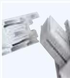
Die unsichtbaren „**Powerverbinder**“ in den Ecken. 8 Eckverbinder werden zusätzlich mit dem PVC des Türflügels verschweißt und verkrallen sich in den Ecken mit dem Stahlkern der Tür. Damit erreicht man eine hochstabile Eckverbindung und höchste Verwindungssteifigkeit
